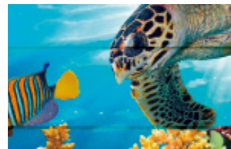
Sobreposição / faixas pretas (quantidade insuficiente de alimentação)
